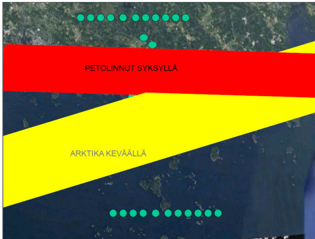
Kuva x: Kaaviokuva merkittävän lintujen muuttoreitin varrelta Virolahdelta. Kaaviokuva osoittaa, kuinka voimaloita tulisi sijoittaa merkittävän muuttoväylän myötäisesti.
