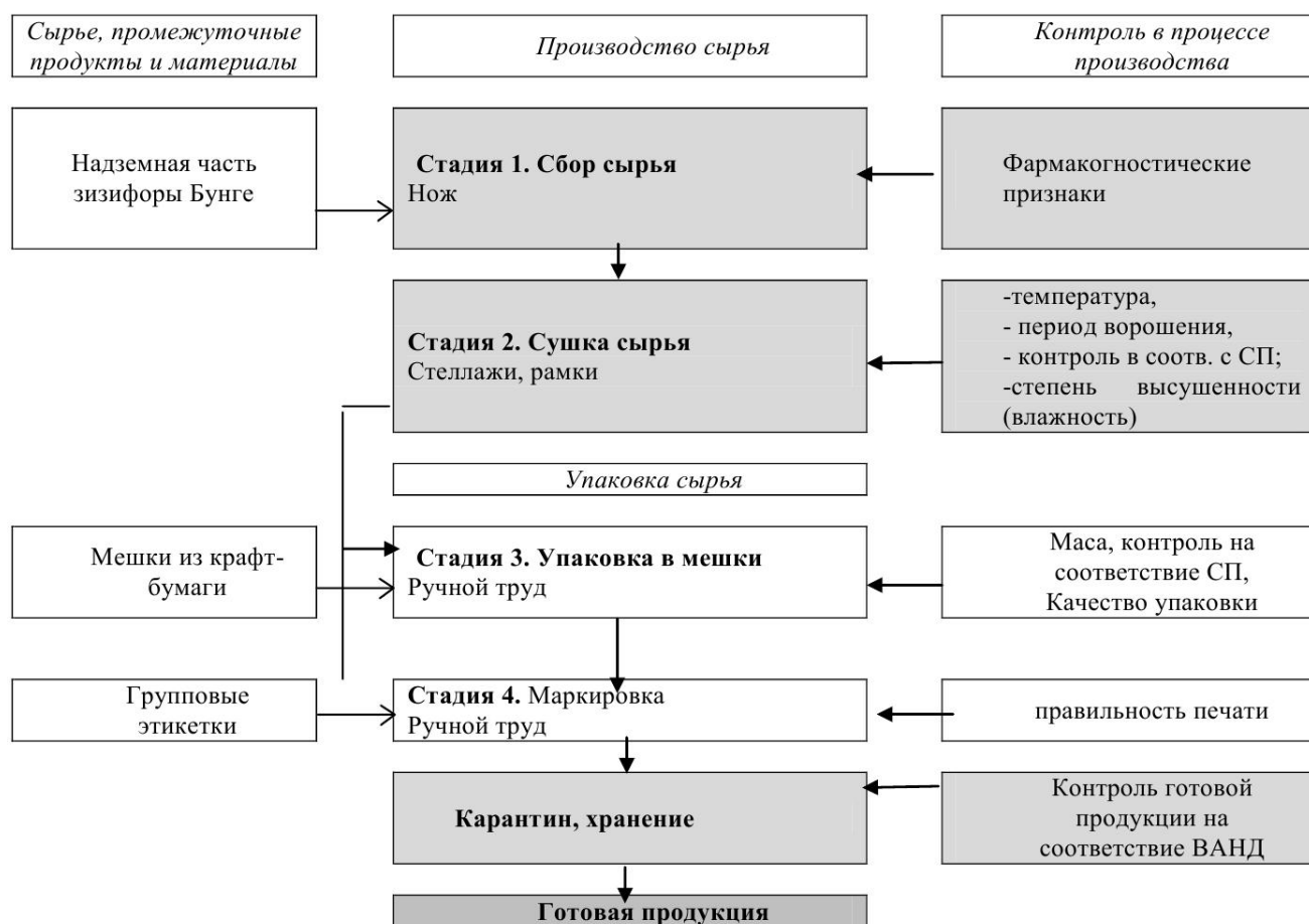
Рисунок 3 - Технологическая схема заготовки сырья зизифоры Бунге
