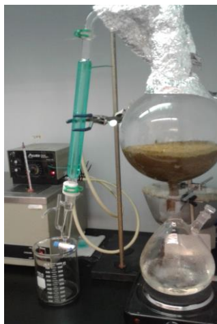
Рисунок 19 - Перегонка с водяным паром сырья репешка азиатского
