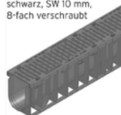
Typ 75 mit Gussrost, schwarz, SW 10 mm, 8-fach verschraubt
