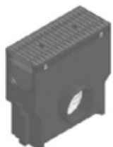
Einlaufkasten mit verzinktem Eimer und FIBRETEC Design Stegrost, SW 9 mm, schwarz, Klasse B125, arretiert
