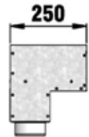
Schnittdarstellung Ablaufbox mit auspfasterbarer Innenwanne
