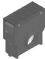
Einlaufkasten mit verzinktem Eimer und Guss-Längsstabrost, KTL-beschichtet, Klasse C 250, arretiert
