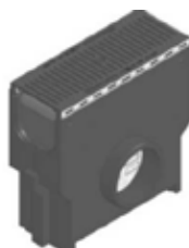
Einlaufkasten mit verzinktem Eimer und Gussrost SW 6 mm, schwarz, Klasse C250, arretiert
