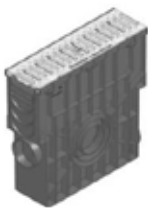
Einlaufkasten mit Kunststoff-Eimer und Doppelstegrost, SW 80/10 Klasse C 250, arretiert
