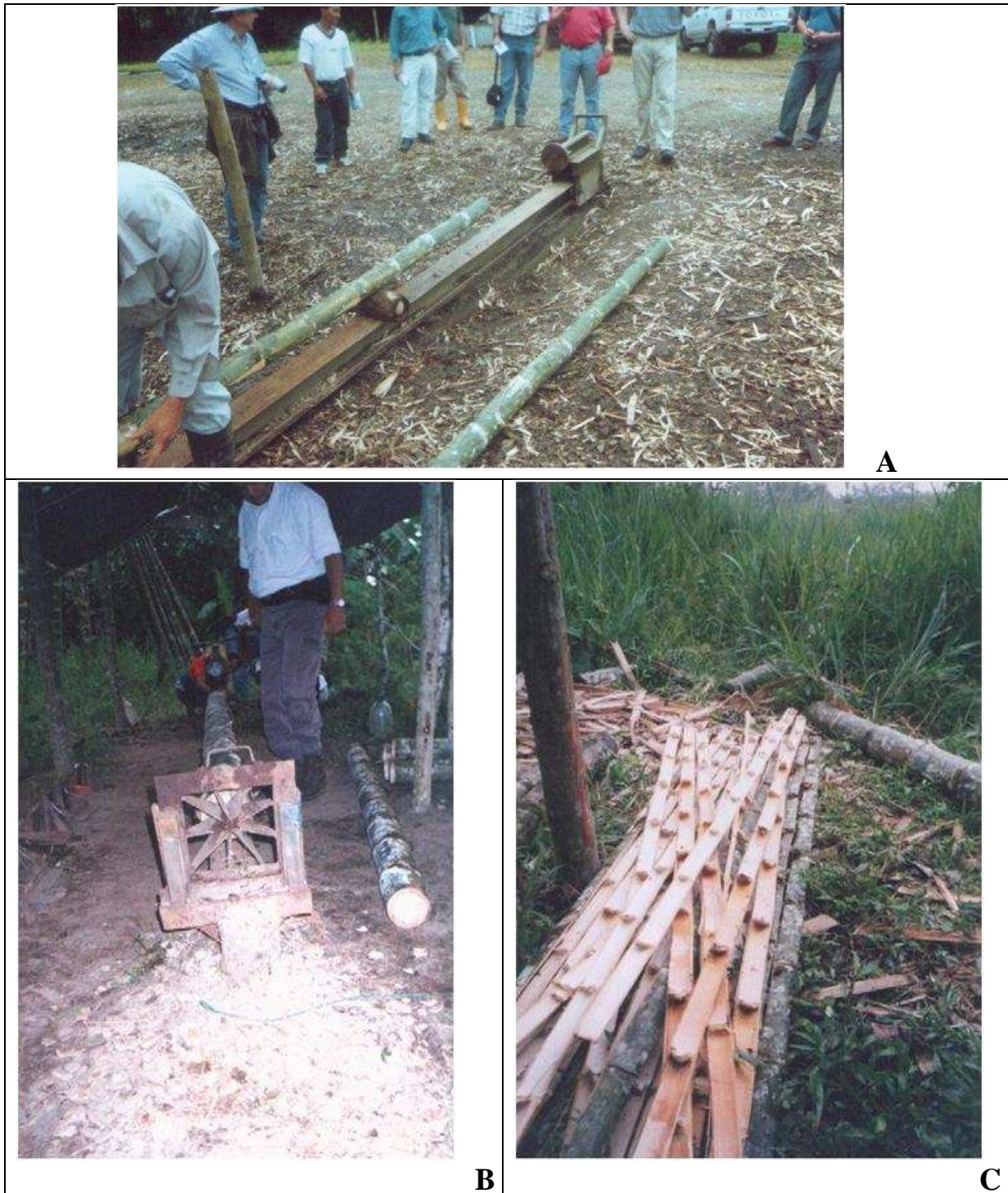
FIGURA N°61: Producción de Latillas a partir de Cañas de Bambú: (A) latilladora manual; (B) latilladora en operación; (C) latillas producidas
