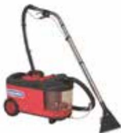
Handliche Sprühextraktionsmaschine für den professionellen Einsatz. Durch leichte und kompakte Bauweise vor allem bei kleineren Grund- und Unterhaltsreinigungen ideal, mit zwei Sprühpumpen und zwei Düsen-Adapter ( 26 cm ) für erhöhte Sprühmenge. Das Gerät verfügt über Chromstahlhandrohr und Chromstahlrohr.
