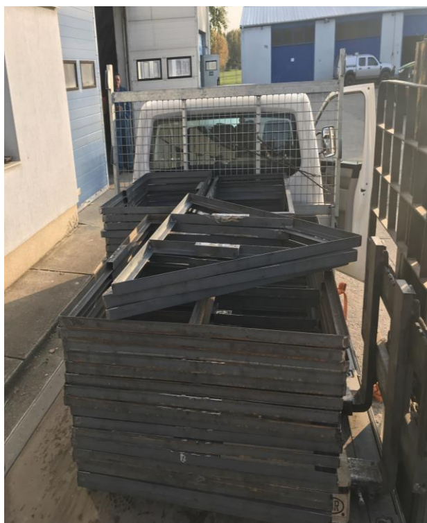
53. kép A Kiskörei szakaszmérnökség lakatos műhelyében elkészült tábla tartó keretek szállítása tüzhorganyzásra, és jelőtábla rögzítése a már korrózióvédelemmel ellátott keretre
