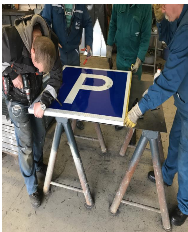
53. kép A Kiskörei szakaszmérnökség lakatos műhelyében elkészült tábla tartó keretek szállítása tüzhorganyzásra, és jelőtábla rögzítése a már korrózióvédelemmel ellátott keretre
