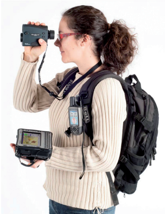
Obr. 10.8 Minimálna zostava na automatizovaný zber údajov pre modelovanie lesa pozostáva z terénneho mobilného počítača, navigačného prístroja a laserového diaľkomera (obrázok prevzatý z Wikimedia Commons ).
