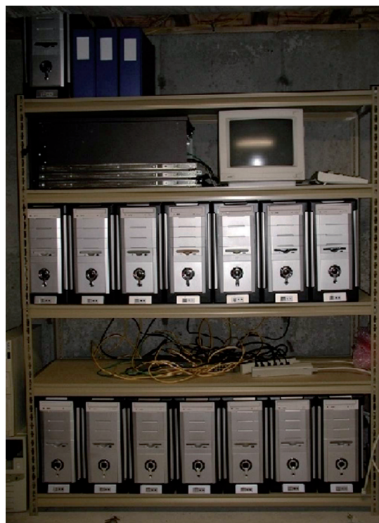
Obr. 10.40 Cluster typu Beowulf zložený z viacerých identických komerčných počítačov prepojených v lokálnej sieti (obrázok prevzatý z Wikimedia Commons).
