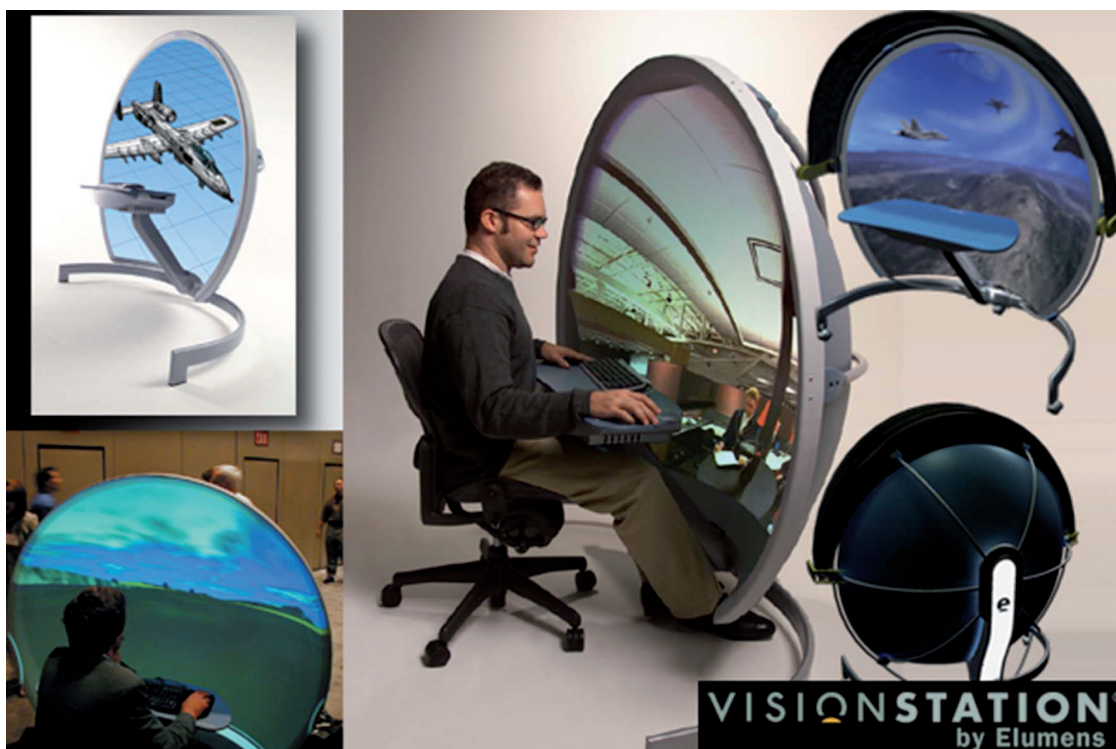
Obr. 10.42 Stanica Vision od firmy Elumens zobrazuje obraz na veľkoplošnej parabolickej obrazovke, čím mu dáva výrazný imerzívny charakter (obrázok prevzatý z webovej stránky Elumens).
