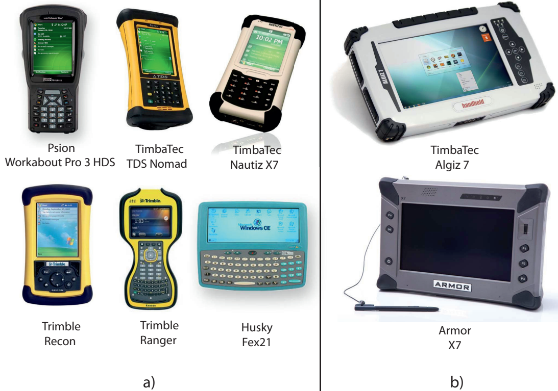
Obr. 10.6 Príklady terénnych počítačov pre zber údajov v modelovaní lesa: a) vreckové počítače, b) plnohodnotné tablety (obrázky sú prevzaté z webových stránok výrobcov a distribútorov).
