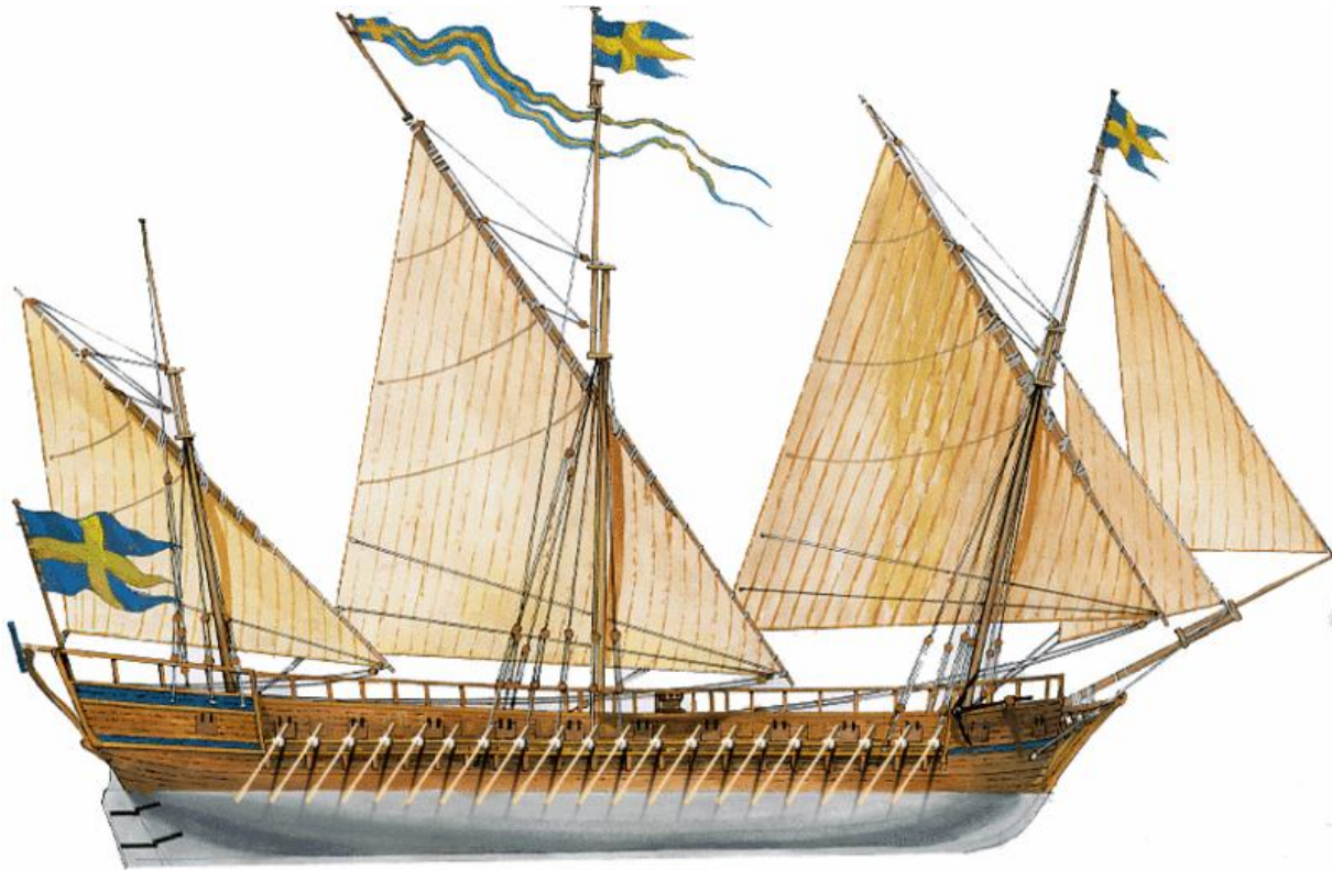
71., 72. ábra: A Chapman-féle szigettengeri flottilla számára 1770-ben tervezett hemmema terve. Az oldalütegsoros, evezős-vitorlás az utójára épített latinvitorlás evezős, egyben a Chapman-féle galeaszsz-tervhez legjobban hasonlító hadihajó.
