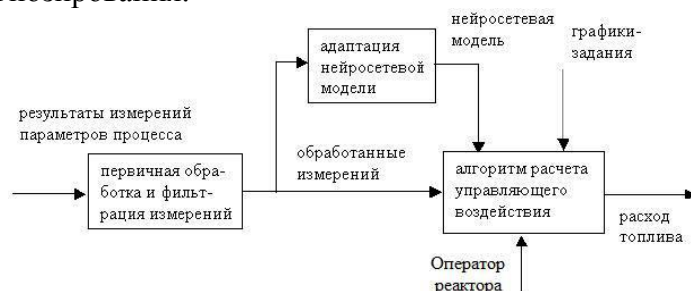
Рис. 3. Функциональная схема управления реактором
