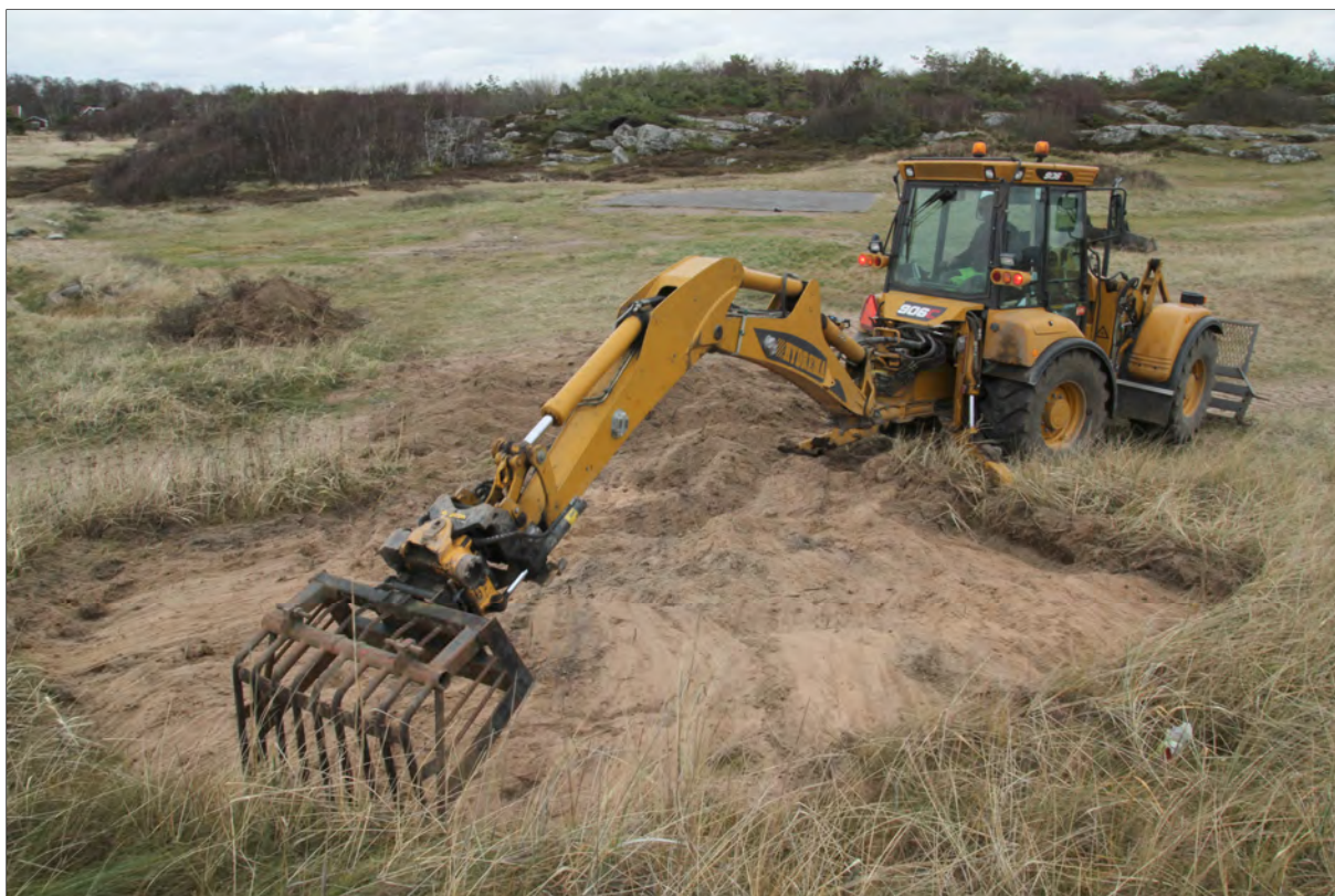
Med gällerskopa grävs vresrosorna upp så att sanden "kammas" för att få bort rötter och annat organiskt material. Resultatet blir även ett värdefullt område med bar sand, hösten 2010. Foto Kill Persson.
