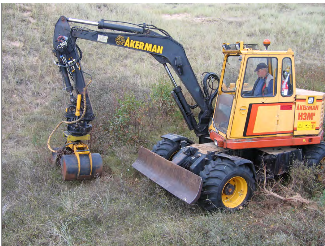
Hjulgrävare som med klämskopan nyper kring och rycker upp lövsly. Materialet kan sedan köras bort eller brännas i högar. Foto Kill Persson.
