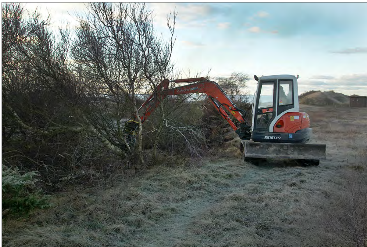
Även med en mindre grävare (3,5 ton) med grip och rotortilt rycks träd och buskar lätt upp. Foto: Kill Persson.
