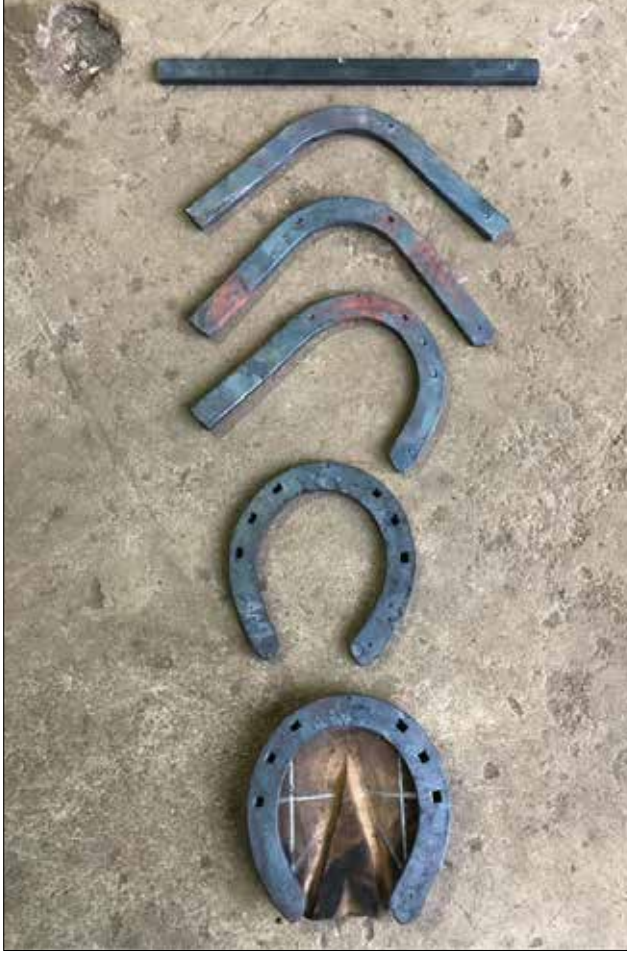
Resim 49: El yapımı nal aşamaları
