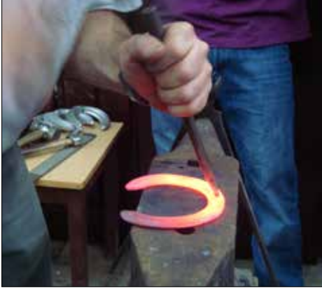
Resim 138. Nalın yaprak kısmının açılması
