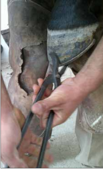
Resim 182. Nalı çakmak ve perçinleri hazırlamak
