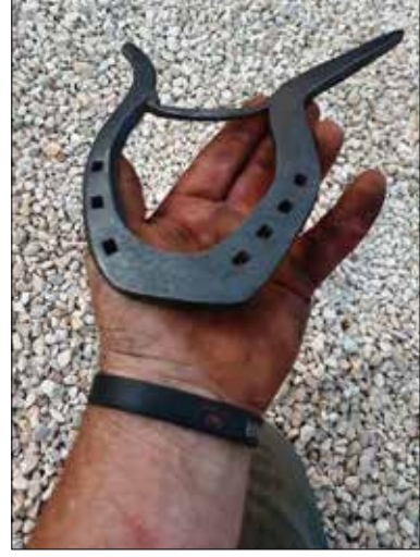
Resim 94. Kol uçları değişik şekillerde uzatılmış nal
