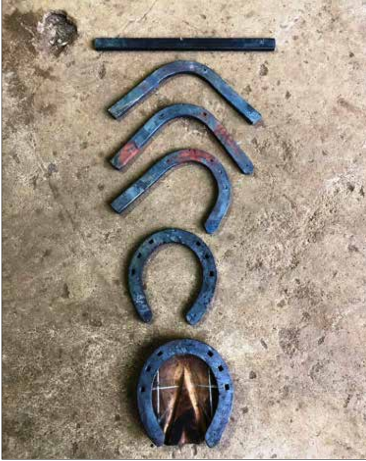
Resim 171. Sıcak nallamada nal yapım aşamaları
