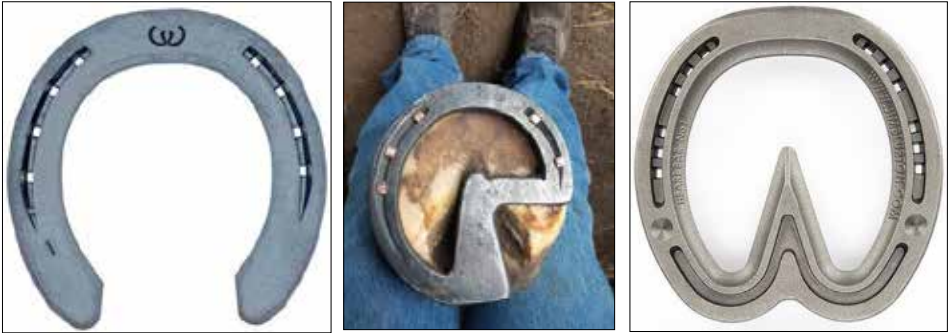
Resim 82. Tırnak çatlağı nalı
