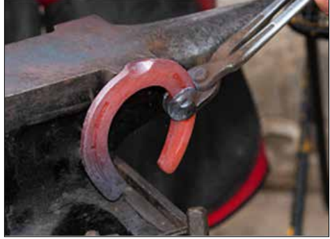
Resim 138. Nalın yaprak kısmının açılması
