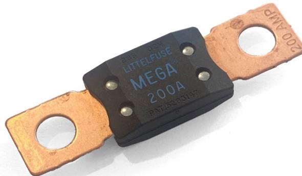
Sollte aus irgendeinem Grund in einem Fahrzeug ein Kurzschluss entstehen, fliesst ein grosser Strom von den Batterien durch die Kabel. Zu grosse Ströme können Kabel erhitzen und Brände auslösen. Damit keine zu grosse Ströme fließen können, baut KYBURZ am Kabel zum Pluspol der Batterie eine Sicherung ein.
