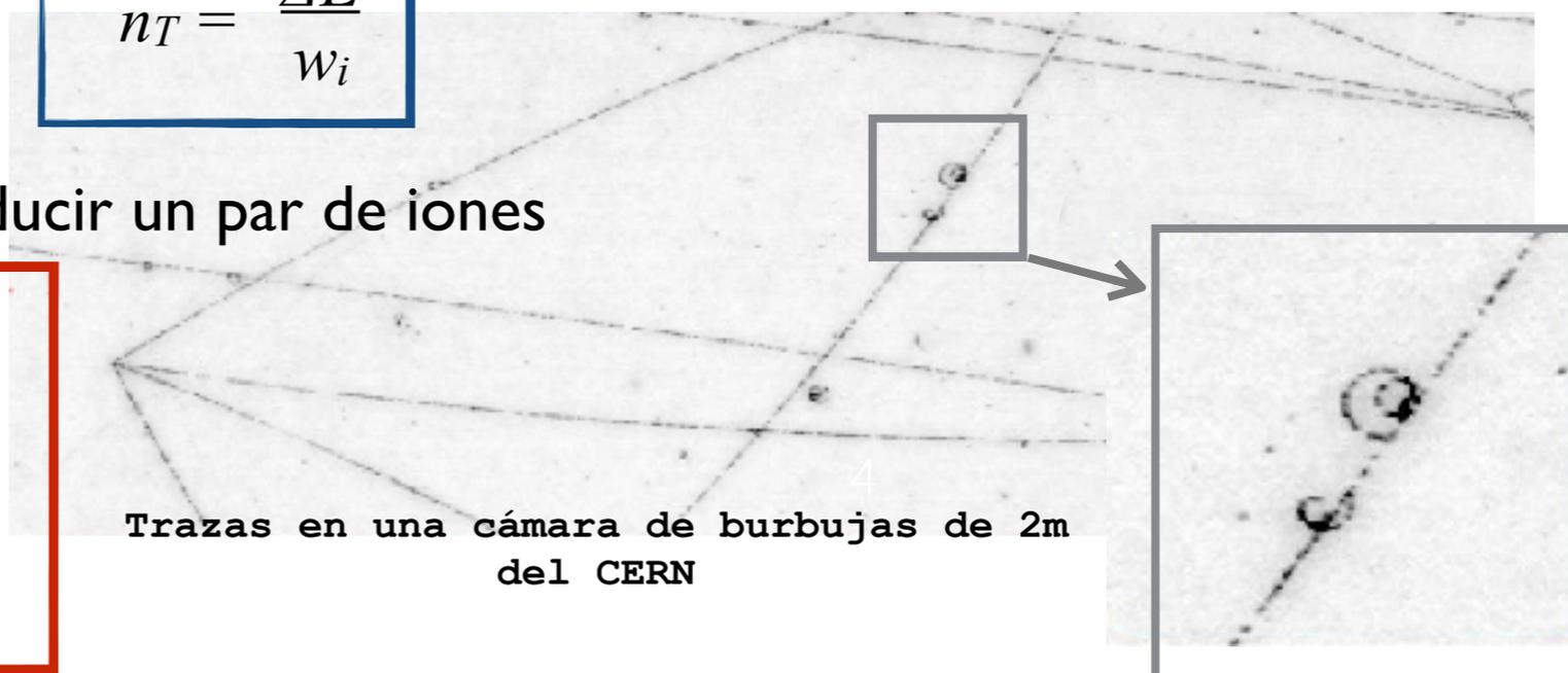
Trazas en una cámara de burbujas de 2m del CERN
