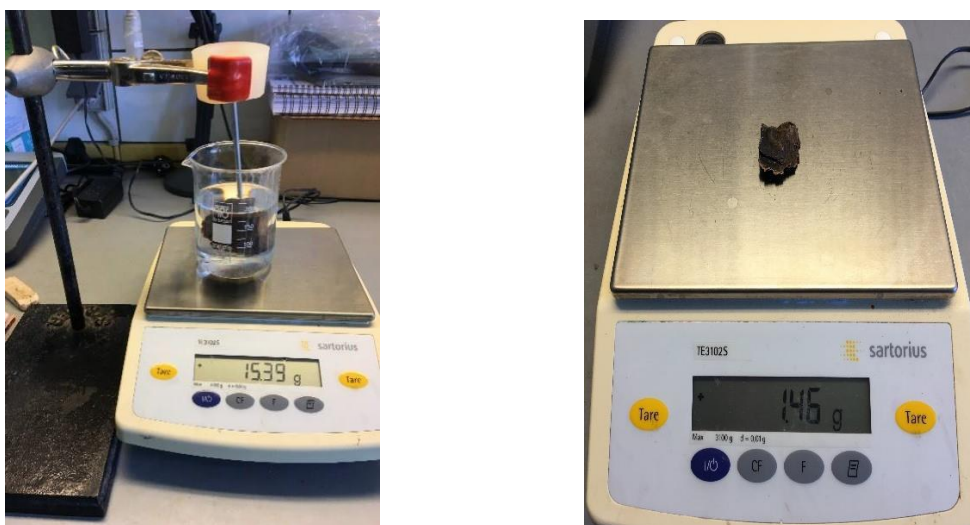
Figur 24 Vægten af vanddrukket træprøve i vand og efter ovntørring
