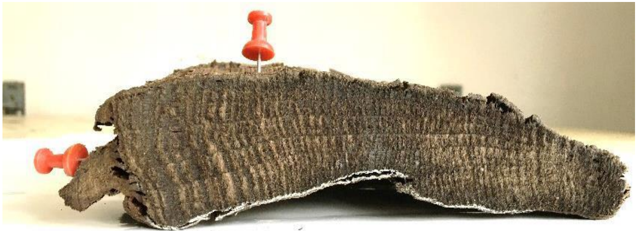
Figur 29 Tørret egetræsbrøndplanke. Splintveddet til venstre er skrumpet helt ind.
