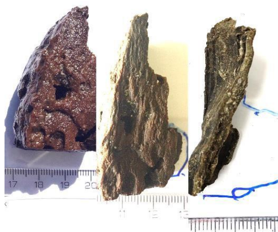
Figur 30 Prøve fra stammebåd lufttørret over 14 dage.
