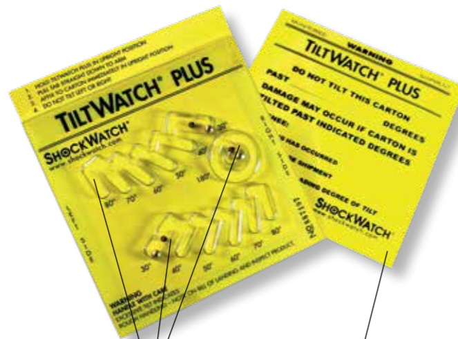
Blistersegmente, die durch Kugeln den Neigungsgrad anzeigen
