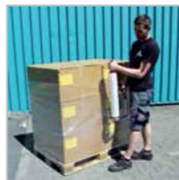
Mit dem Abrollgerät die Palette umwickeln
