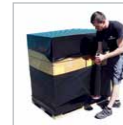
Palettenabdeckblattauflegen und mit Stretchfolie fixieren
