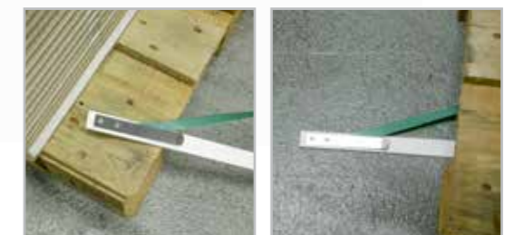
Band in Clip einklemmen, unter der Palette durchschieben
