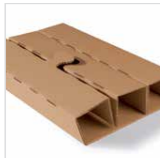
Den flachliegenden Zuschnitt der Innenverpackung von rechts und dann von links einfallen und mittels Stecklasche in der vorgestanzten Öffnung fixieren.
