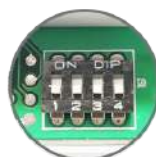
DIP Switch Réglage courants
