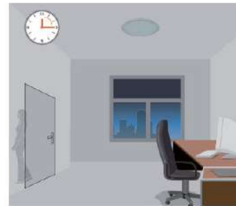
Le capteur éteint la lumière automatiquement après un certain temps s'il n'y a pas de mouvement détecté
