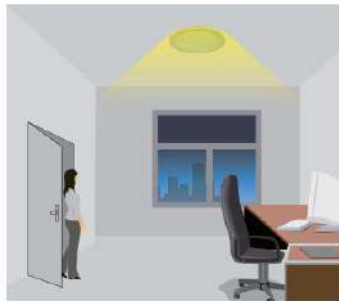
Si la lumière naturelle est insuffisante, le DP s'allume automatiquement lorsqu'une personne entre dans la pièce
