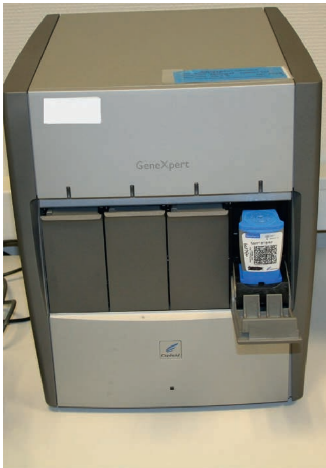
Fig. 5.1 Exemple d'automate de PCR en temps réel (GeneXpert®, Cepheid). (Photographie : Michel Auzou.)
