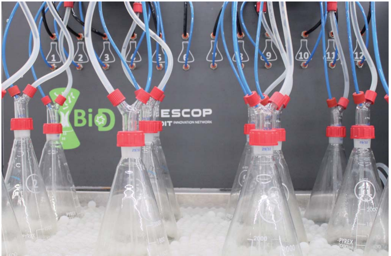
Vista general del equipo de biodegradación en medio líquido basado en la norma ISO20136:2017.
