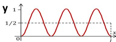
$$I = \frac{1}{2} c * y^2 \left( \frac{m}{s} \frac{N}{m^2} \right) \text{ bzw. } \left( \frac{W}{m^2} \right)$$
