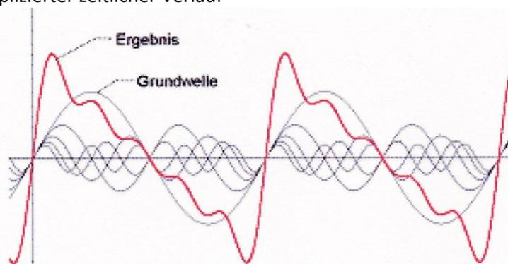
Frequenzspektrum eines Klanges, resultierend aus einem reinen Ton überwiegender Schallstärke und einer Zahl schwächerer Obertöne höherer Frequenz und die resultierende Well (nach google „grundwelle obertöne klang“).
