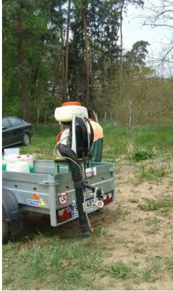
Obr. 89: Motorový rosič firmy Stihl – typ SR 200
