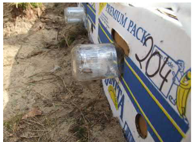
Obr. 79: Detail záchytného prostoru fotoeklektoru
