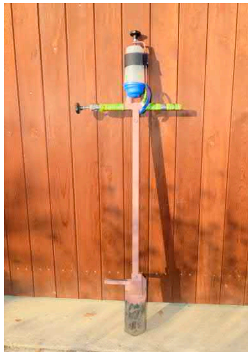
Obr. 24: Upravený sazeč pro aplikaci přípravku Force 1,5 G ke kořenům sazenic
