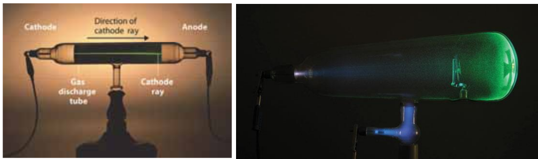
FIGURE 25.1 – Les instruments d'expérience de rayons cathodiques de Thomson
