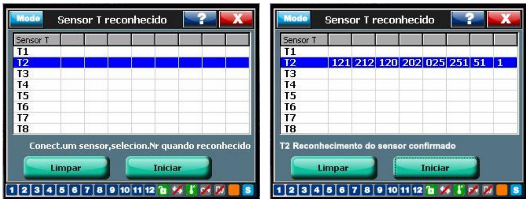
Figura 45: Reconhecimento automático da sonda de temperatura
