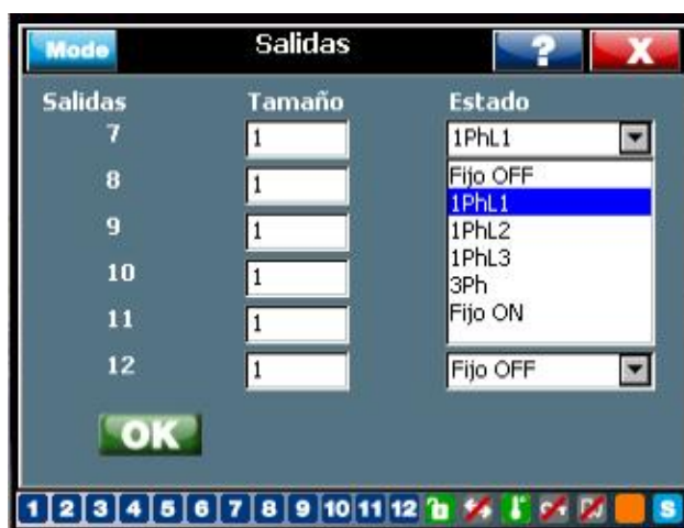
Figura 29: RVT salidas 7-12 (modelo trifásico RVT12-3P)
