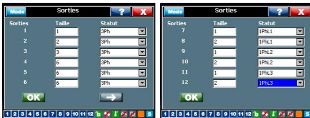
Figure 31: Programmation courante de sortie 6 x 3ph + 6 x 1ph (modèle triphasé RVT12-3P)
