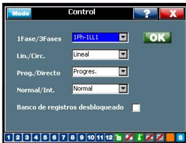
Figura 34: Protección de los ajustes de la batería del RVT: no protegidos
