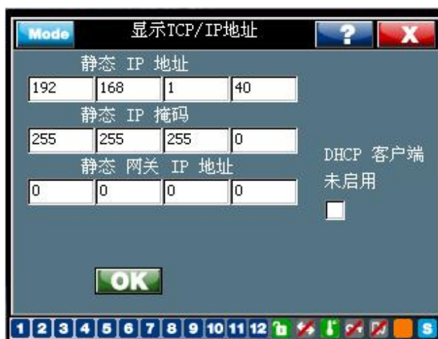
图 56: RVT TCP/IP 协议设定
