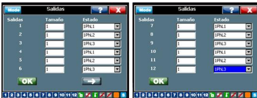
Figura 30: Ajuste habitual de las salidas 12 x 1ph (modelo trifásico RVT12-3P)
