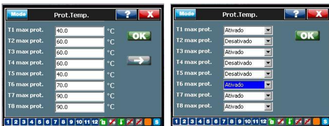
Figura 41: Configurações da proteção de temperatura do RVT
