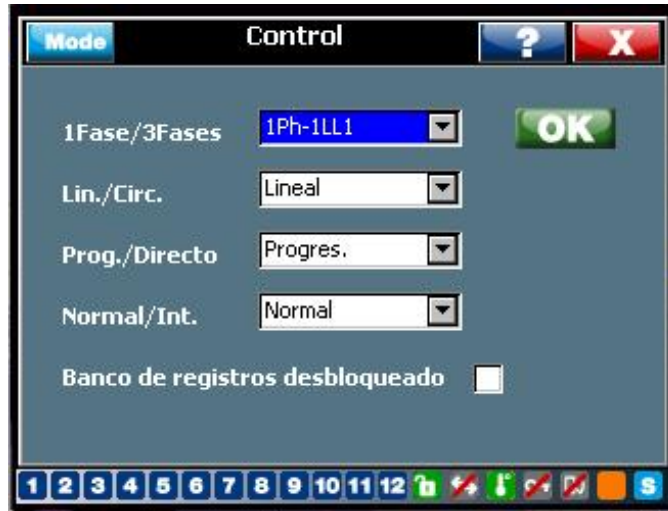
Figura 33: Ajustes de control de la batería del RVT
