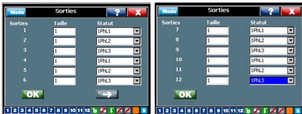
Figure 30: Programmation courante de sortie 12 x 1ph (modèle triphasé RVT12-3P)
