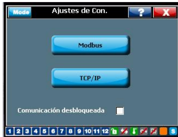
Figura 54: Ajuste del protocolo de comunicaciones del RVT
