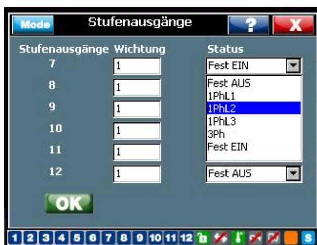
Abbildung 29: RVT Ausgänge 7-12 (Drehstrom-Modell RVT12-3P)
