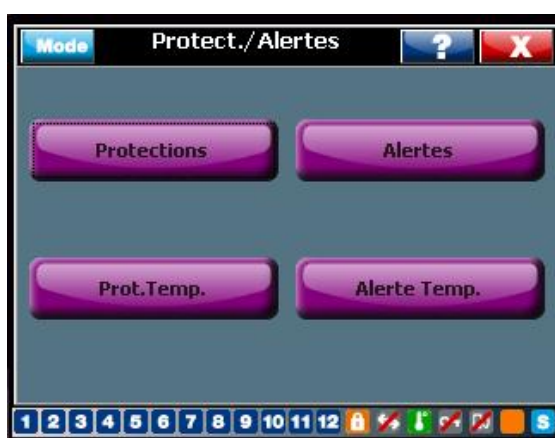
Figure 39: programmation des protections et alertes du RVT
