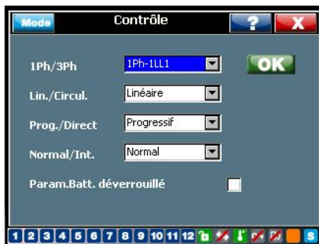
Figure 34: Protection de la programmation batterie: non protégé
