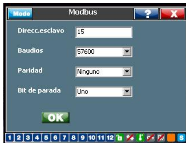
Figura 55: Ajuste del protocolo Modbus del RVT
