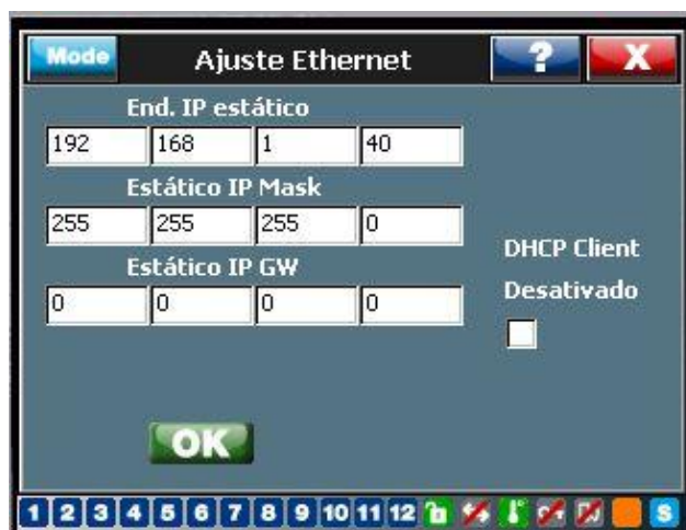
Figura 56: Configurações de protocolo TCP/IP
