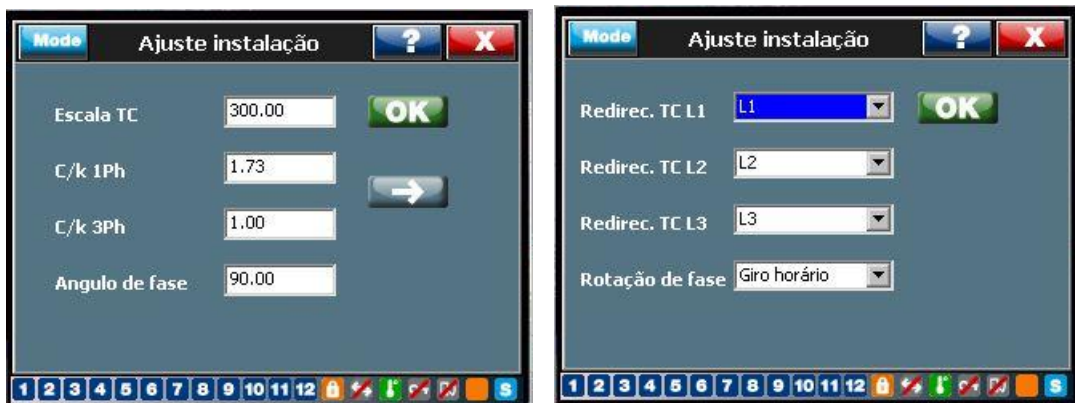
Figura 35: Configurações de instalação do RVT
