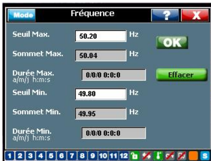
Figure 25: Enregistrement du seuil - Fréquence
