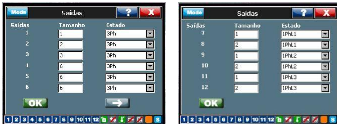
Figura 30: Configuração típica para 6 capacitores trifásicos + 6 monofásicos (modelo RVT12-3P)
