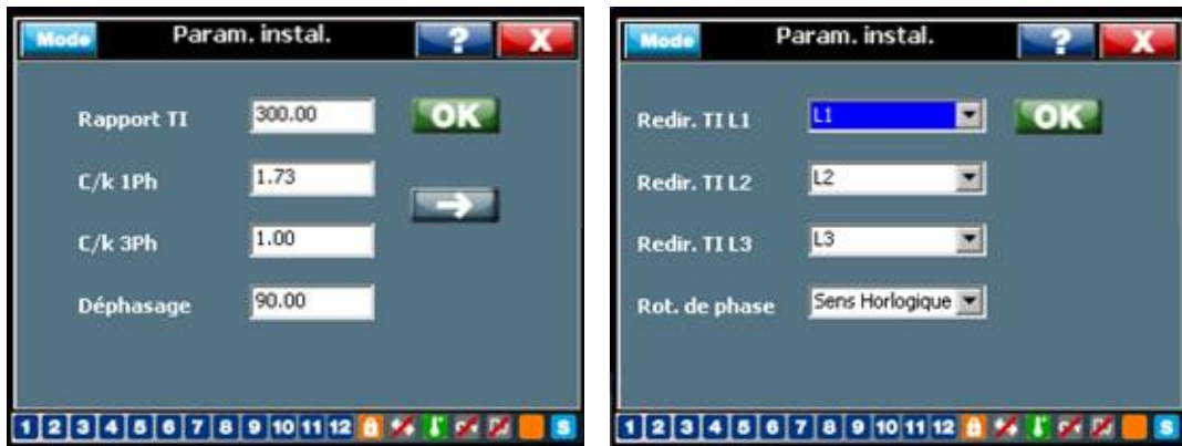
Figure 36: Paramètre d'installation du RVT
