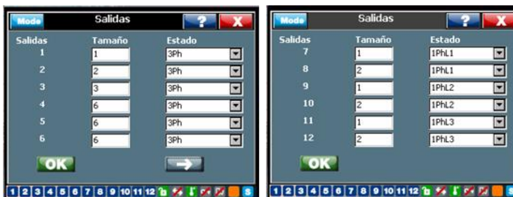
Figura 31: Ajuste habitual de las salidas 6 x 3ph + 6 x 1ph (modelo trifásico RVT12-3P)
