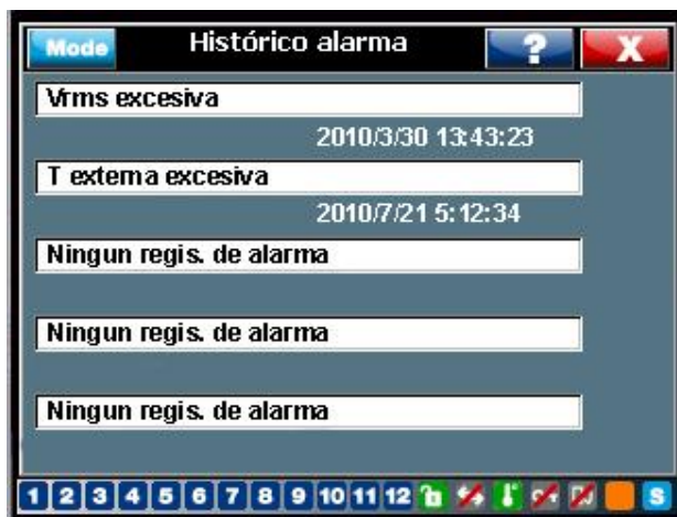
Figura 50: Control batería histórico alarma
