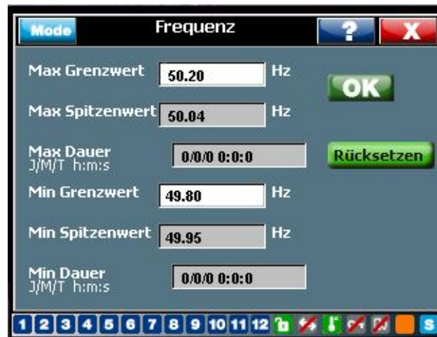
Abbildung 25: Ereignisspeicher Schwellwert-Einstellung - Frequenz
