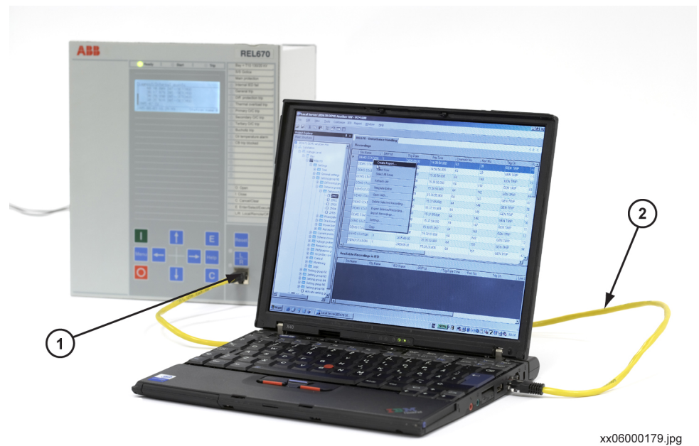
Figure 18: Connecteur en face avant du DEI
