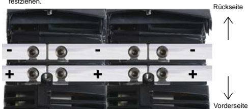
Abbildung 5: Anschließen von Sammelschienen zur gemeinsamen Nutzung des Gleichstrombusses
