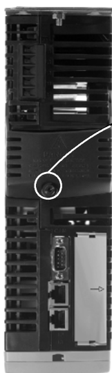
Abbildung 5: Anschließen von Sammelschienen zur gemeinsamen Nutzung des Gleichstrombusses
