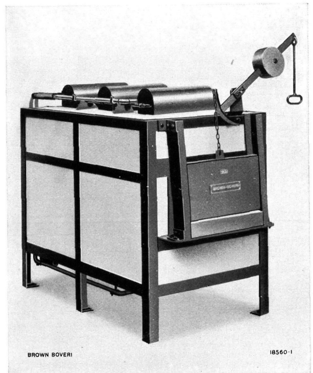
Abb. 2. — Elektrischer Glühofen Type Gth 12 b. Glühraumabmessungen 1200 \times 440 \times 250 mm, Glühtemperatur bis 1000^\circ C, Anschlusswert bis maximal 40 kW.
