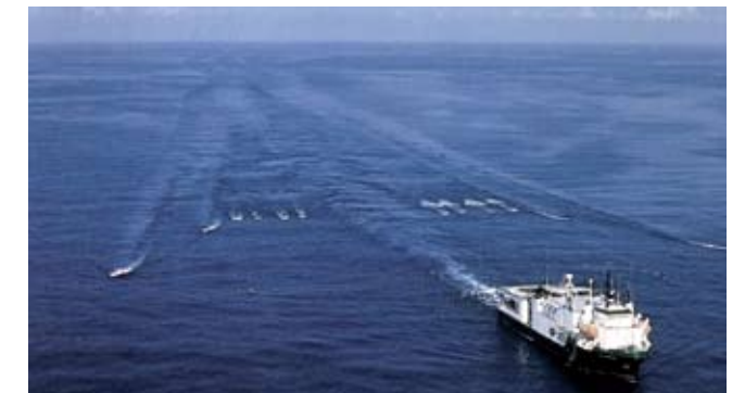
Navio sísmico arrastando os cabos sismográficos e hidrofones
