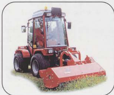
Supertrac m/Orsi slag klipper, mod. GF 1600, kuttebredde 1,6 m.
