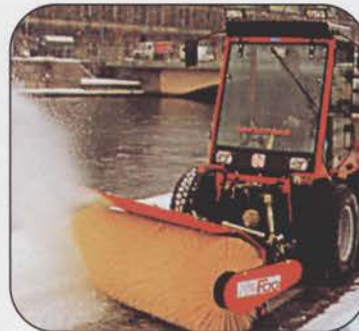
Snørydding på kunstgress. Superpark 4400 HST, 40 hk Fres bort det meste av snøen med en 2 trinns fres på hjul, deretter kan ba- nen feies ren med en kraftig feiemaskin. Be om referanser.
