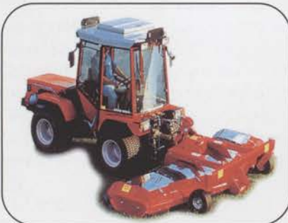
Supertrac, HTM 50 og 75 hk, reversibelt førerkonsoll, Midjestyrt og hydrostat transmisjon
