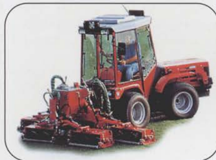
Supertrac m/ Sylinderklipper, mod. FLM5. Kuttehoder med 6 blader, kuttebredde 3,2 m.
