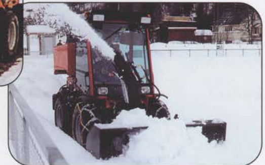
Snørydding på kunstgress. Superpark 4400 HST, 40 hk Fres bort det meste av snøen med en 2 trinns fres på hjul, deretter kan ba- nen feies ren med en kraftig feiemaskin. Be om referanser.
