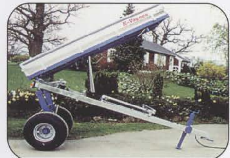
K- vagnen 4000 HT3, størst i serien, med en maksimal løfte- høyde på 1600 mm. Passer veldig godt som høytipper i dressmaskin, for golf- baner og containere. K-mek lager vogner med golfbanedekk fra 0,8-4,0 t.
