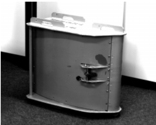
Abb. 2: Schwingerträger zur hydroakustischen Bestandsschätzung in flachen Gewässern
