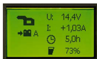
Die aktuellen Batterie-Daten: Spannung, Strom, Restlaufzeit, Kapazität
