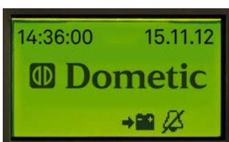
Startanzeige: Durch Drehen des Knopfes gelangt man in die Menüs
