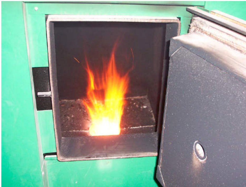
Abb. 43: Wirbelbrennkammer mit Roggen bei Volllast, 45 kW
