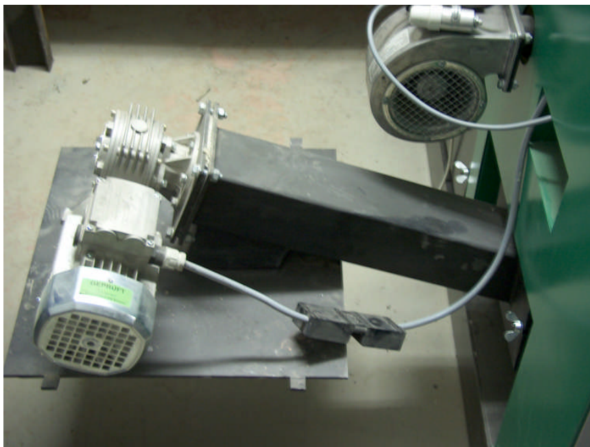
Abb. 7: Austrag der Asche über eine Schnecke (hier: ohne Aschekasten)
