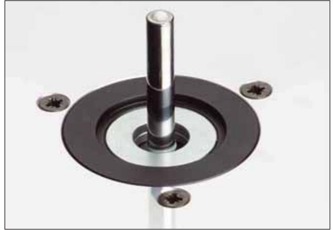
Das invertierte Tellerlager mit eingepresster Keramikugel. Der Magnetring entlastet den Lagerspiegel und verringert so das Rumpeln
