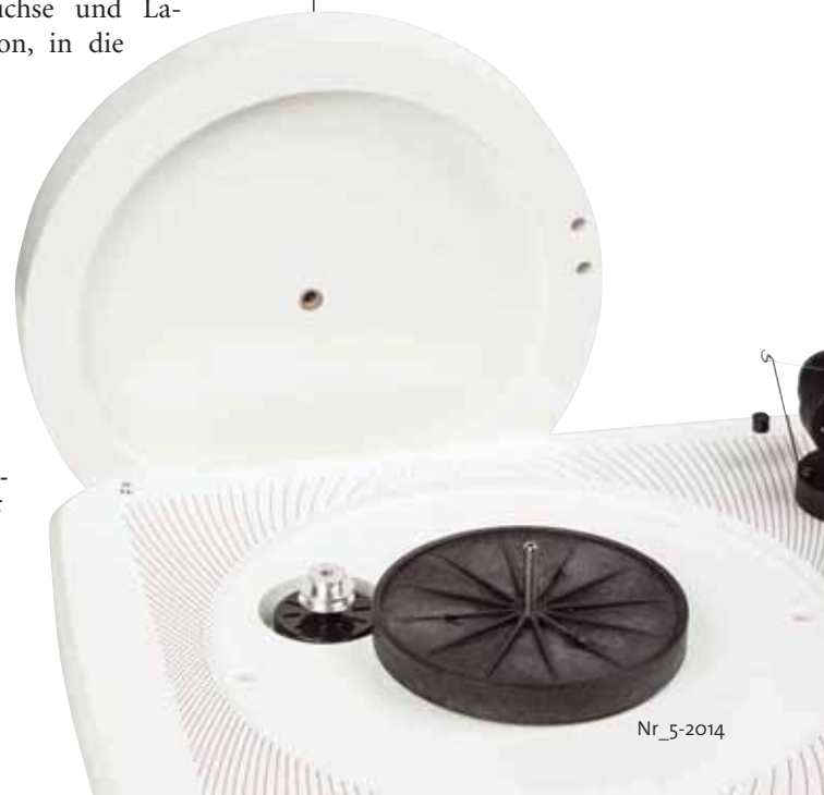
Der Hauptteller aus MDF wird mit Bohrungen vor dem Lackieren feingewuchtet
