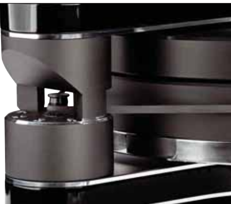
Der Antriebsmotor steckt in einem der drei Zylinder außen an der Antriebseinheit, die Kraft überträgt ein Flachriemen
