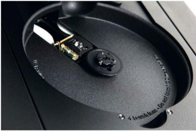
Zwei Griffmulden über der Laufwerks-„Schale“ erleichtern das Einlegen einer Disc. Die Klappe selbst „klappt“ nicht, sondern fährt über einen trickreichen Mechanismus nach hinten.
