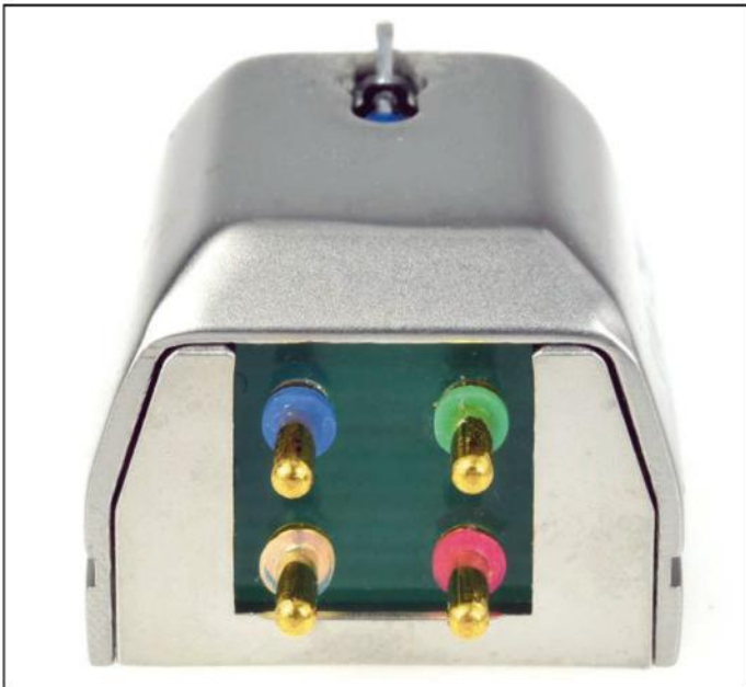
Die Farbkennzeichnung der Anschlüsse entspricht genau jener bei herkömmlichen Tonabnehmern. Vier Pole genügen für die Stromversorgung und die Ausgangssignale. Mit versorgt wird eine blau leuchtende Betriebsanzeige an der Vorderfront des Tonabnehmers.
