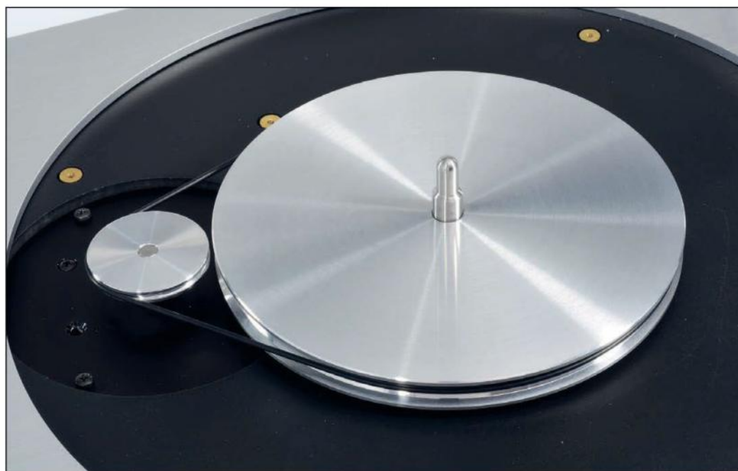
Der hochpräzise gefertigte Subteller braucht eine ganze Weile, bis er sich komplett in das Lager abgesenkt hat. Nach dem Aufsetzen des eigentlichen Tellers ist vom Lagerdorn nicht mehr viel zu sehen. Eine Startautomatik sorgt für einen riemenschonenden Anlauf des Motors bzw. Tellers.
