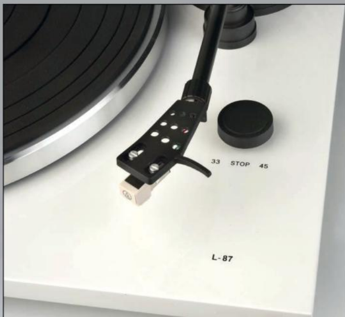
Die Headshell des Tonarms kann man abschrauben. Das ist praktisch, wenn man Nadeleinschub oder Tonabnehmer wechseln und/oder wenn man weitere Tonabnehmer in weiteren Headshells vorhalten möchte, etwa für Mono-Schallplatten.
