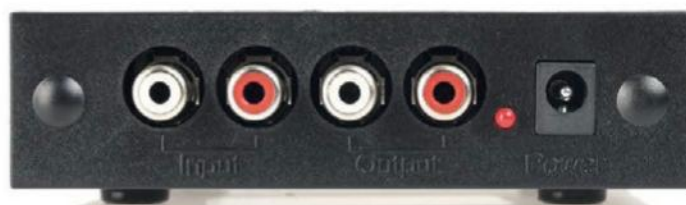
Die rote LED informiert über den erfolgreichen Anschluss des 24-Volt-Steckernetzteils, das Wechselspannung liefert; der Rest des Netzteils inklusive Regelung steckt ebenfalls unter dem Gehäuse.
