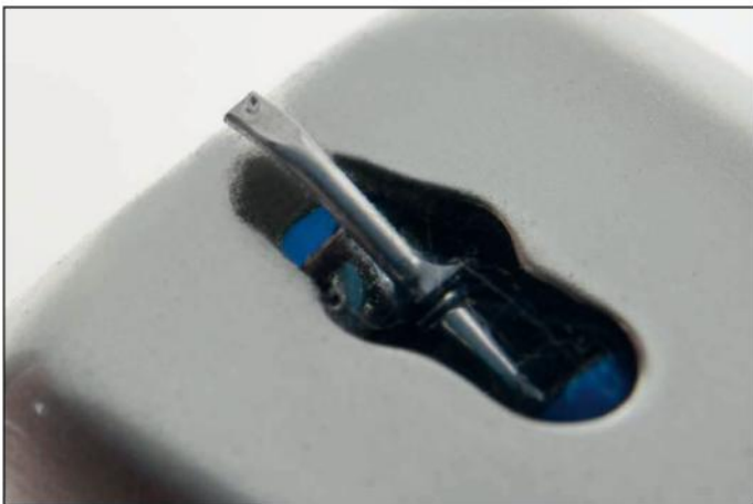
Im kleinsten Modell des optischen Abtasters kommen eine Nadel mit Shibata-Schliff und augenscheinlich ein Aluminium-Nadelträger zum Einsatz, der mit einem Spanndraht versehen ist.
