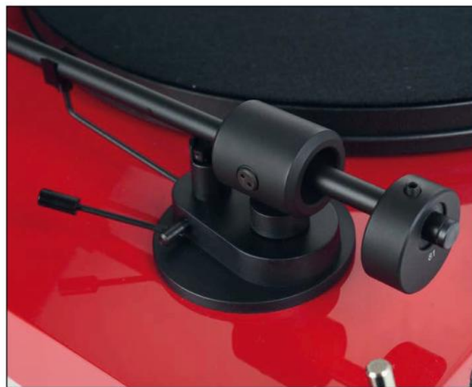
Der 8,6-Zoll-Arm der Juke Box E ist ab Werk komplett justiert. Antiskating, Auflagekraft und Tonabnehmer sind eingestellt, man kann sofort loslegen.
