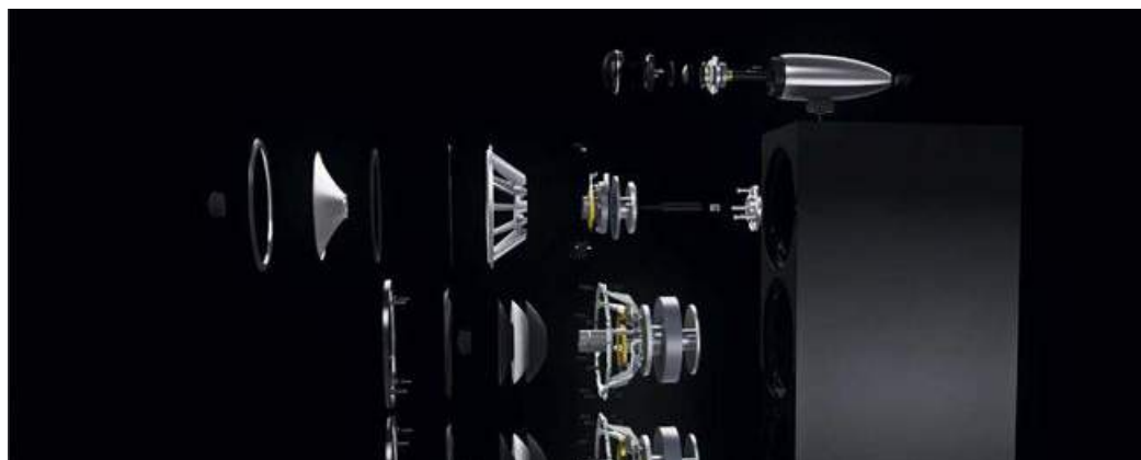
Die Darstellung zeigt die extreme Komplexität der Chassis mit viel massivem Alu in der Befestigung derselben. Bei Hoch- und Mitteltöner sieht man die entkoppelnde Dämpfungsverschraubung von hinten, während bei den Bässen dreilagige Membranen und eine sehr tief bauende Schwingspule dominieren.
