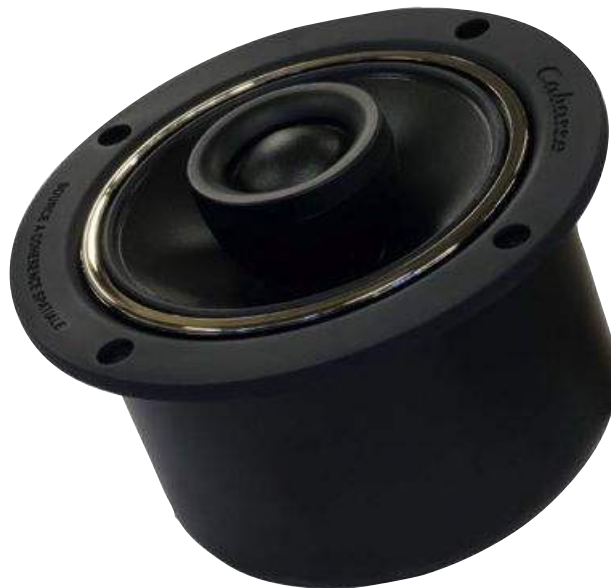
Cabasse ist Spezialist in Sachen Koax. Statt einer eigenen Membranringgeometrie hat dieser Pseudokoax eine 10-cm-Polypropylen-Membran für den Mittelton und eine 27-mm-Gewebekalotte, die zur Reflexionsminimierung auf einem Rohr weit vor dem Konus sitzt.
