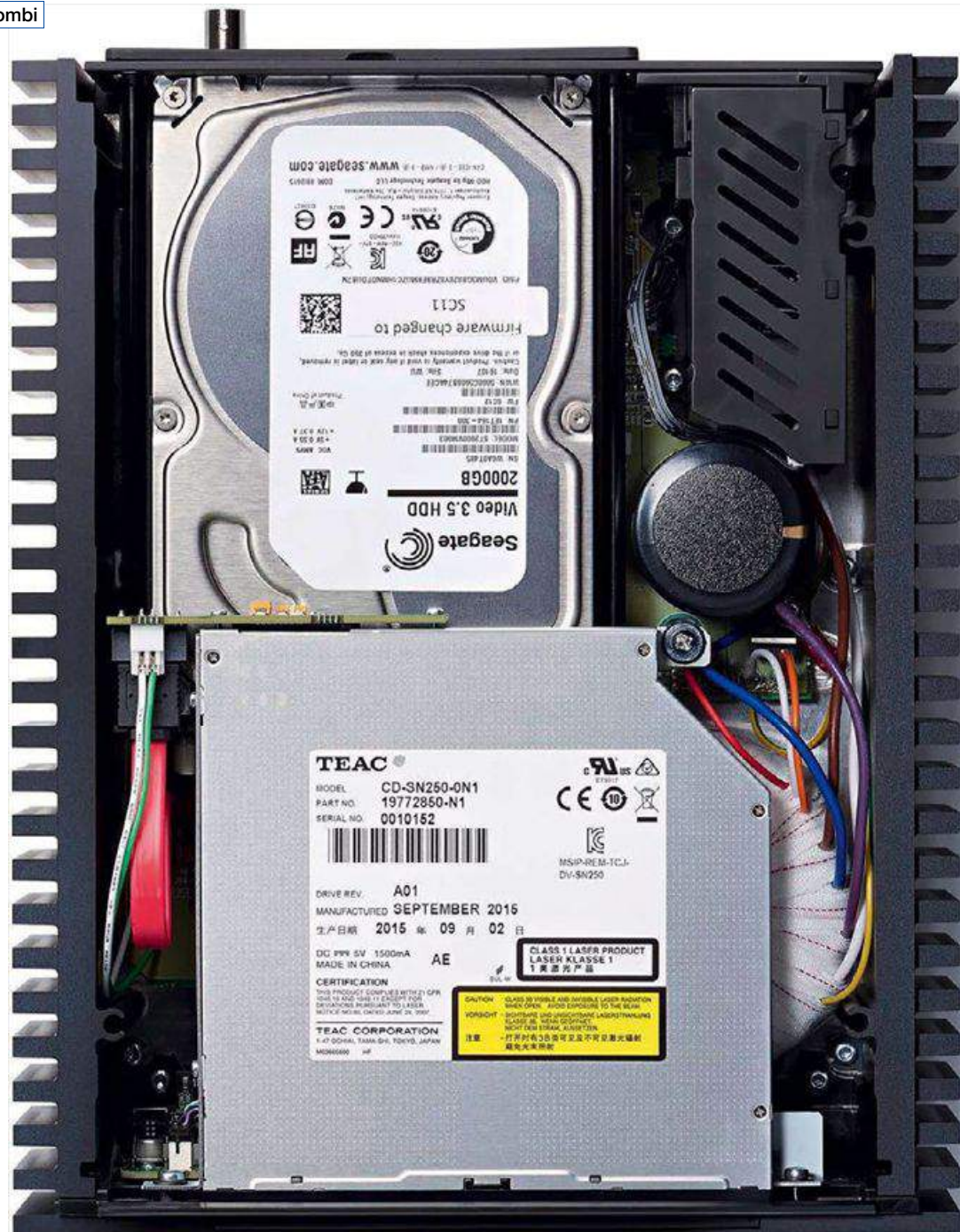
Endlager: Das TEAC-Schlitzlaufwerk des Musikservers Uniti Core soll durch reichlich RAM trotz voller Lesegeschwindigkeit klangstarke CD-Kopien auf Festplatte ermöglichen. Das Rippen startet automatisch durch das Einschieben einer Silberscheibe. Nach vier bis fünf Minuten wird sie automatisch ausgeworfen. Sehen Sie den Ringkerntrafo? Die Briten bevorzugen manchmal noch analoge Old-School-Lösungen.
