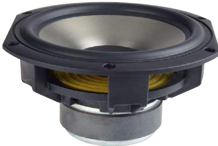
Das 17-Zentimeter-Basschassis ist sowohl auf Leichtbau wie auf Steifigkeit und großen Hub hin optimiert. Die Schwingspule auf einem Kapton-Träger ist hinter der sehr großen Zentrierspinne großzügig ventilert, was Kompression und Verzerrungen minimiert.
