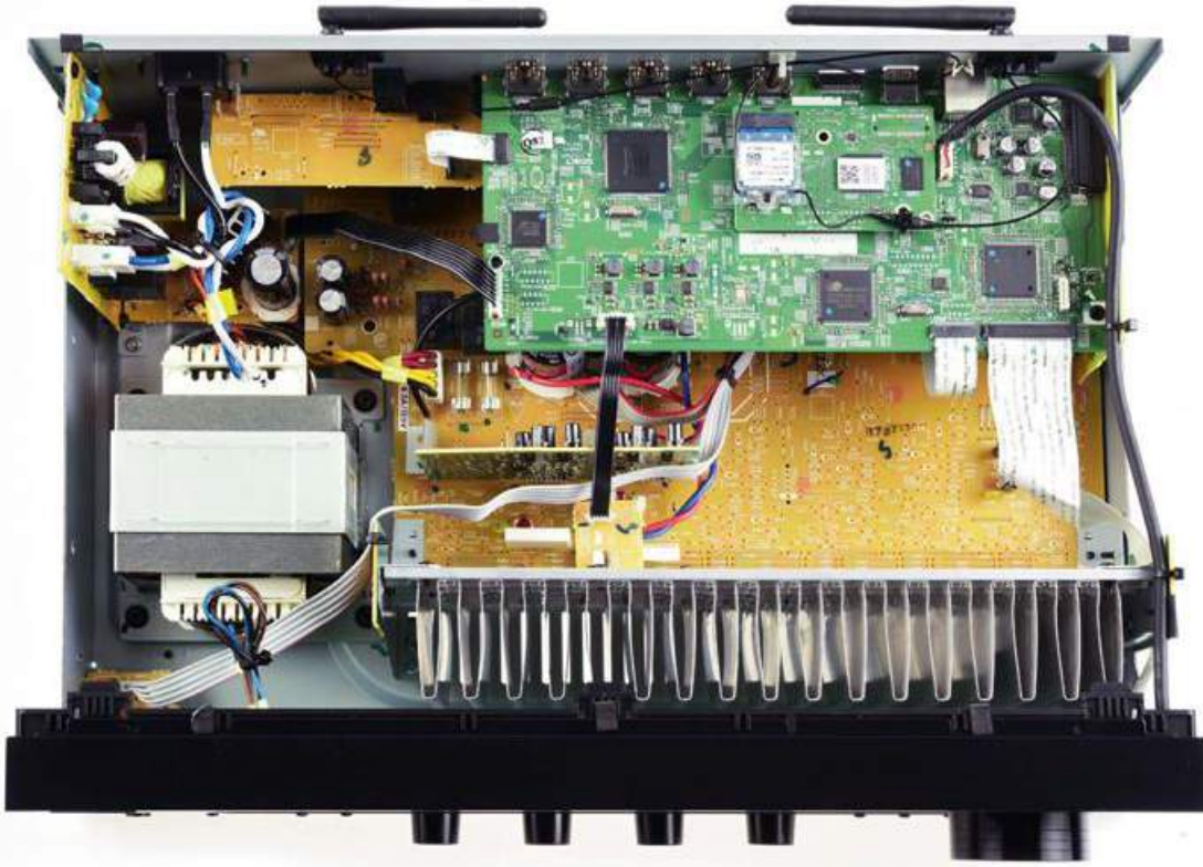
Im TX-8270 geht es gedrängt zu. Kein Wunder: Netzteil, Kühlkörper und Platinen brauchen Platz, schließlich beherrscht der Onkyo neben klassischer Verstärkung auch Streaming, D/A-Wandlung und bringt ganz nebenbei auch ein sehr erwachsenes Bassmanagement für den Betrieb eines Subwoofers mit.
