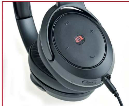
Die Logo-Taste aktiviert das ANC. Weitere Buttons steuern die Wiedergabe und Telefonie.
