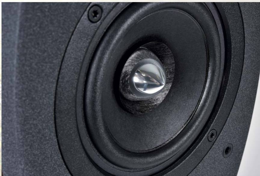
Der Breitbänder bekam für das 8.2-Update einen Feinschliff. Ein Papierring als Schwirrkonus im Zentrum der glasfaserverstärkten Verbundmembran ist für die Höhen zuständig.
