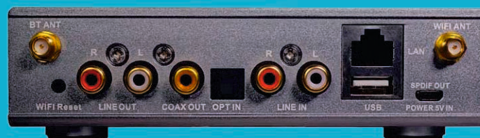
Auf der Rückwand befinden sich analoge und digitale Aus- und Eingänge. Serienmäßig ist die Ausstattung mit Bluetooth und WLAN.
