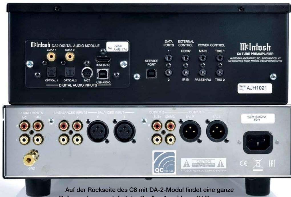
Auf der Rückseite des C8 mit DA-2-Modul findet eine ganze Reihe analoger und digitaler Quellen Anschluss. AV-Prozessoren lassen sich direkt zur angeschlossenen Endstufe durchschleifen.
