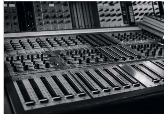
Eigenbau: das Mischpult mit 24 Kanälen in den MPS-Studios
