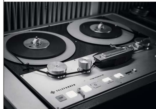
Legende: die Tonbandmaschine Telefunken M 15 für die Master
