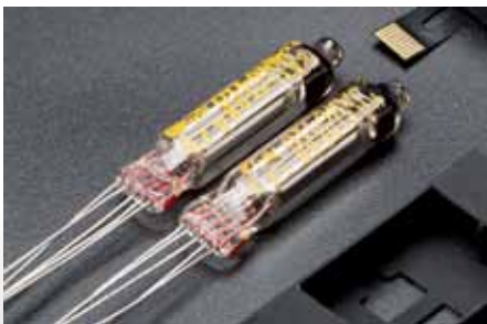
Selektierte Röhren in Silikonlagerung
