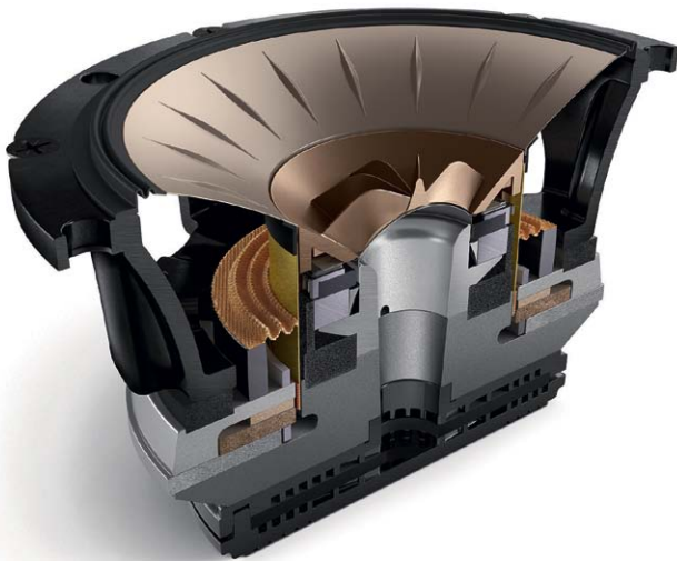
Eine konisch zulaufende Bohrung koppelt die Membran des Hochtöners vorn hinter dem Waveguide an die im Bild schwarze Metamaterial-Struktur, die hinter dem Magneten des Uni-Q-Treibers sitzt.
