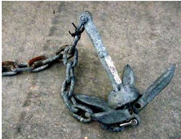
Ancla y cadena colocada en falsete, con una brida, para evitar perderla si se engancha en el fondo
