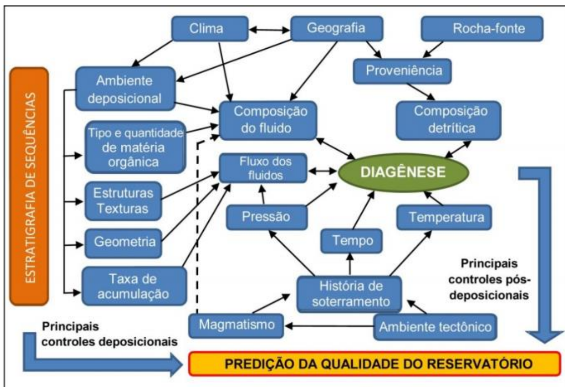
Figura 6. Diagrama mostrando o complexo arranjo de fatores que controlam a diagênese em sedimentos clásticos. A estratigrafia de seqüências pode fornecer informações úteis sobre o ambiente, as estruturas, texturas e composição dos sedimentos e fluidos deposicionais, que possuem controle direto nos processos e padrões diagenéticos (Modificado de Morad et al. , 2012).
