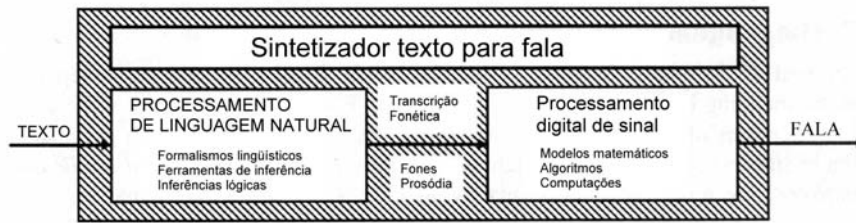
FIGURA 3.4 - Diagrama funcional geral de um sistema TPF [DUT 97]
