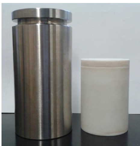
Figura 7. Reator de aço-inox, com cápsula de teflon interna, utilizado neste estudo para reação de síntese zeolítica.
