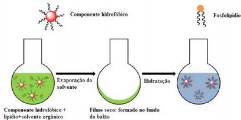
Fig. 5: Esquema do método de hidratação do filme lipídico (Toniazzo, 2013).
