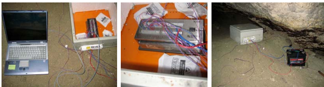
Figur 9, 10 och 11: Från v. Överföring av mätdata / Logger i box / Box och batteri på plats.
