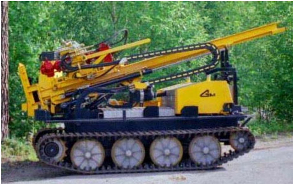
Kuva 6. Maaperäkairauksissa käytettävä monitoimikaira (GeoUnion Oy 2003).
