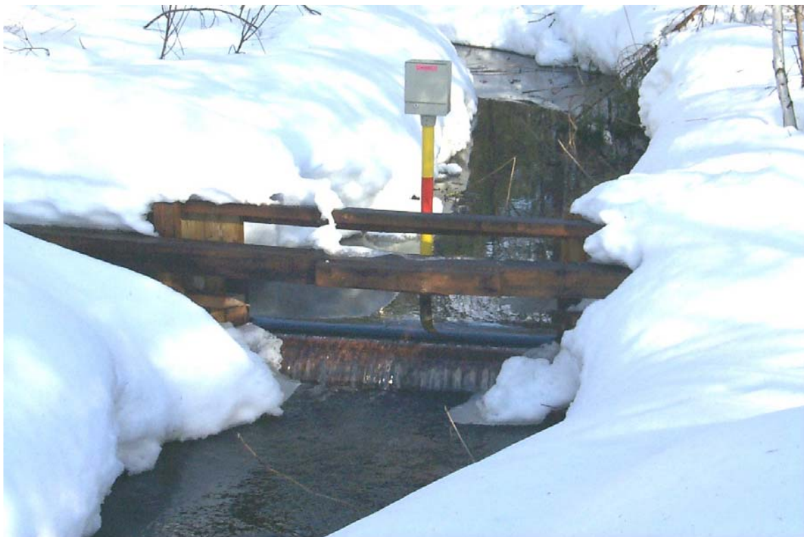
Kuva 11. Mittapato 1 ja automaattinen virtaamamittaus. Keltapunaisen putken sisällä on padon reunan tasolle veden alle sijoitettu paineanturi, joka rekisteröi yläpuolella olevan veden määrän. Mittaustulokset puretaan kannettavaan taskutietokoneeseen (Joensuun Vesi).
