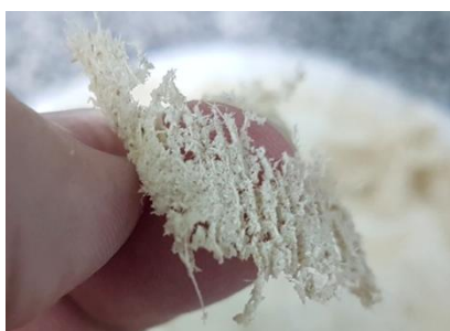
Figura 5. Formação de placas sem a presença de NaOH - 1A1 e 1B1. Fonte: Próprio autor.
