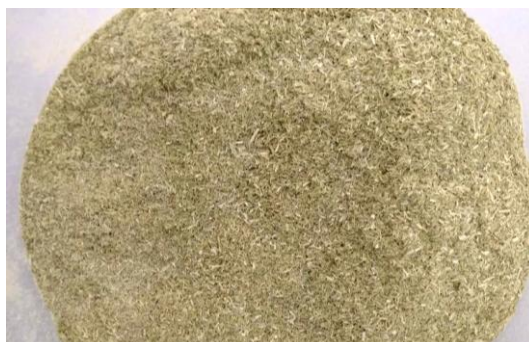
Figura 10. Fragmentação do capim elefante seco - Teste 3. Fonte: Próprio autor.
