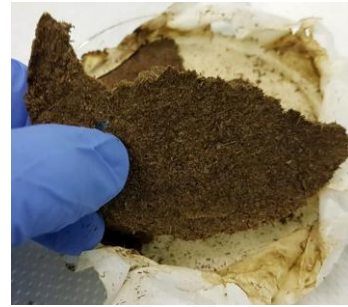
Figura 12. Formação de placa de celulose bruta. C3 e C4. Fonte: Próprio autor.
