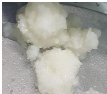
Figura 14. Amostra clareada com NaClO. Fonte: Próprio autor.
