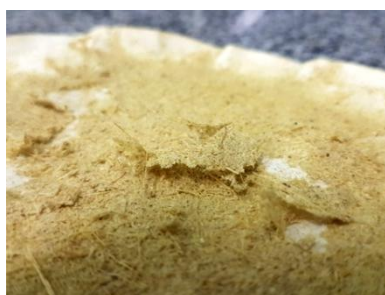
Figura 6. Formação de placas com a presença de NaOH - 1A2 e 1B2. Fonte: Próprio autor.
