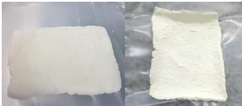
Figura 15. Placa de celulose branqueada úmida / seca. Fonte: Próprio autor.
