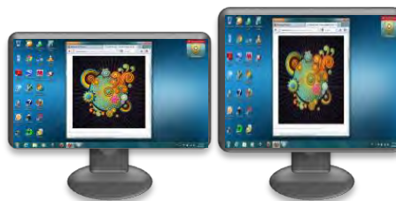
Εικόνα 21 - Δύο οθόνες με το ίδιο μέγεθος (20"), αλλά διαφορετικούς λόγους διαστάσεων 16:9 (αριστερά), 4:3 (δεξιά)
