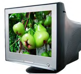
Εικόνα 18 - Οθόνη Καθοδικού Σωλήνα
