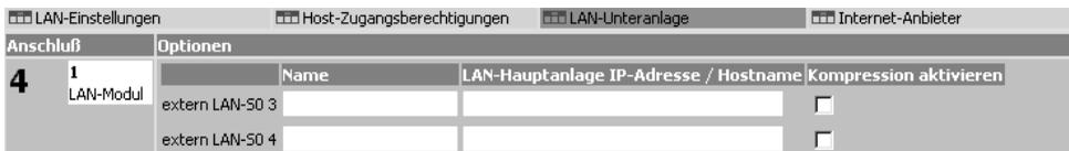
Für die Verbindung mit einem internen virtuellen S0-Bus der Hauptanlage tragen Sie hier die IP-Adresse bzw. IoP-Namen der Hauptanlage ein.
